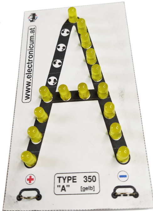
13) Die nächsten 4 Leuchtdioden einstecken. Immer auf die Polarität achten !!! (Widerstand 220 Ohm)
